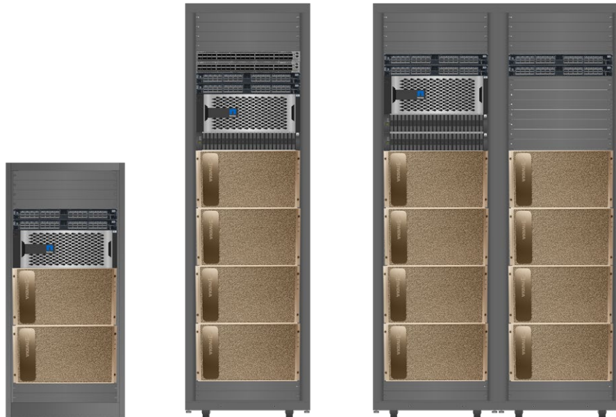
Рисунок 1. Архитектуры ONTAP AI на основе систем DGX A100, конфигурации с 2, 4 и 8 узлами.
